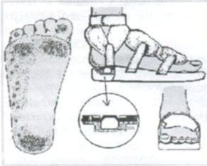
рис 3. Специальный башмак, который имитирует опорную нагрузку. Давление на стопу оказывает сжатый воздух, нагнетаемый компрессором в ритме ходьбы или бега.
